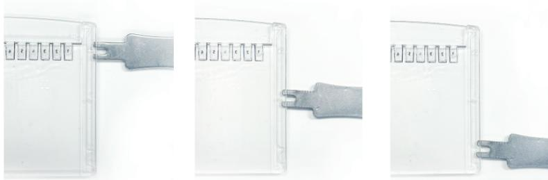
(3) 胶板撬开之后,凝胶可能还会粘在其中一块胶板上,只需将胶板附着凝胶的一侧浸入水中,贴紧水面将其倾斜轻轻提起,凝胶即可脱离,将凝胶从水中取出进行后续实验。
