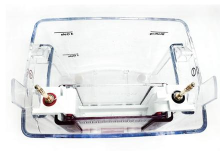
5. 向电泳槽的内槽中加入足量的 **1×Tris/MOPS/SDS 电泳缓冲液**,浸没点样孔并使液面停留在其上方 5 mm 处,接着在外槽中也加入足量的 **1×Tris/MOPS/SDS 电泳缓冲液**,以确保电泳过程中适当的冷却效果;
