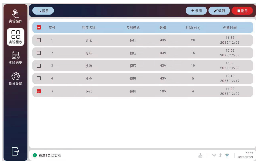
图 4-2 快速转印仪软件实验程序列表界面
